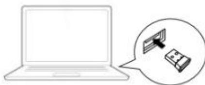
打开鼠标背部电源开关      取出配套USB接收器插入电脑插口
